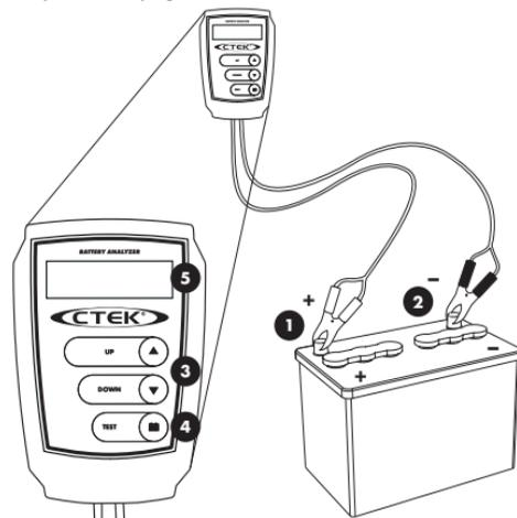
1. Conecte la pinza roja al terminal positivo (+) y la pinza negra al terminal negativo (-). Battery Analyzer se encenderá en cuanto haga ambas conexiones.
