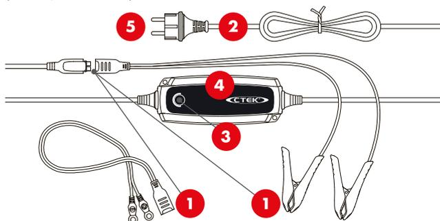
4. Siga el proceso de carga a través del indicador de 8 etapas. La batería estará lista para arrancar el motor cuando se ilumine la ETAPA 4. La batería estará totalmente cargada cuando se ilumine la ETAPA 7.
